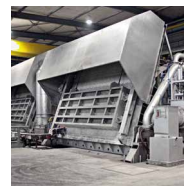
Gießofen GO Warmhalte-/Schmelzofen
