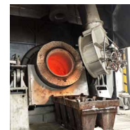
Drehtrommelofen DKO Kippbarer Proben-schmelzofen
