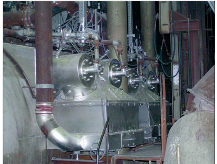
**Bild 2:** PulsReg® Regeneratoren am Aluminium Konverter
